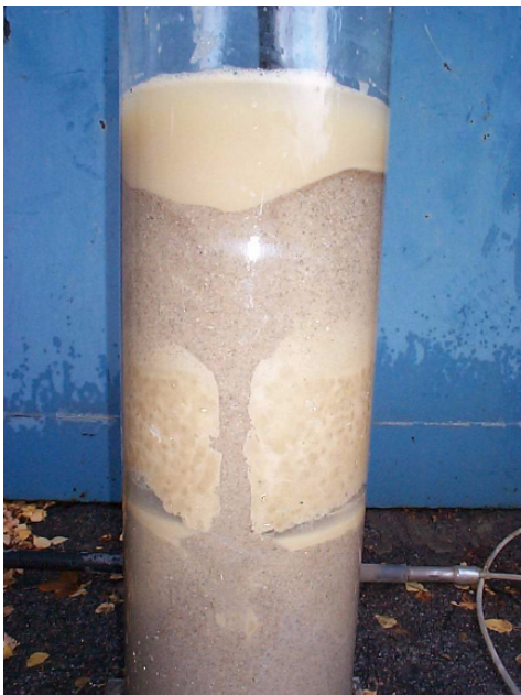
Durchteufte Trennschicht ohne Verfüllung
